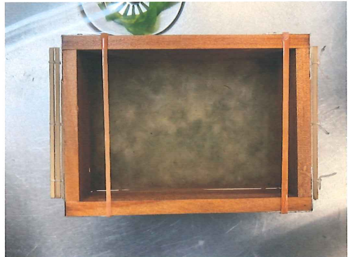
水溜めの中の漉き枠に浸したパルプ
